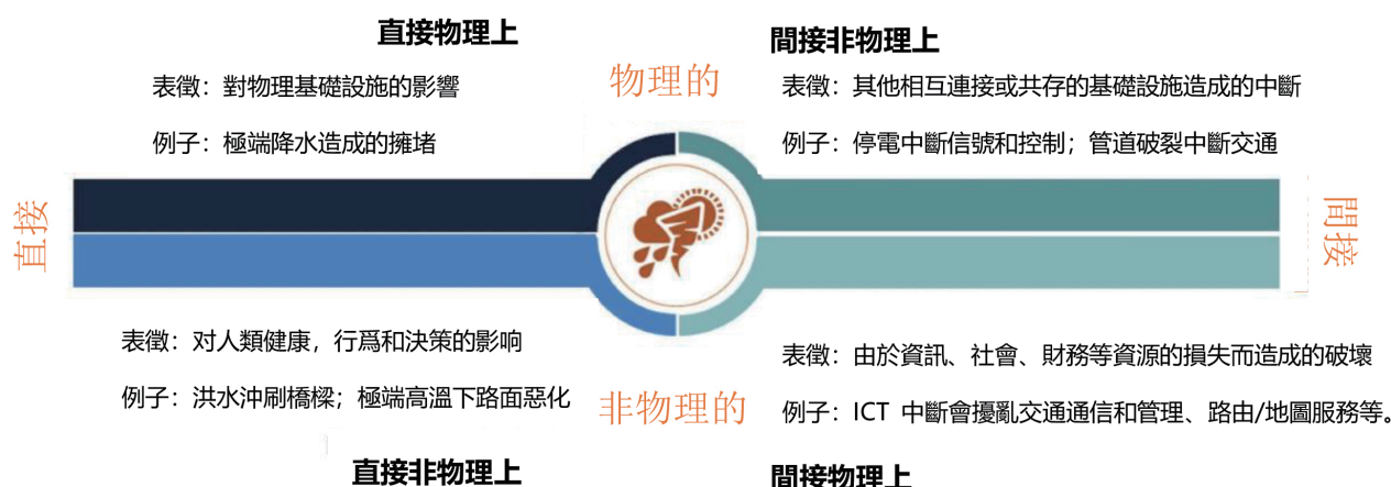
圖 2 極端氣候對交通建設所造成的四種破壞途徑 [2]
